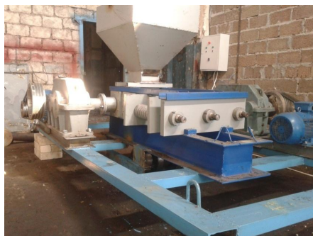
Рис. 4. Пресс-валковый измельчитель с дезагломерирующим устройством.
