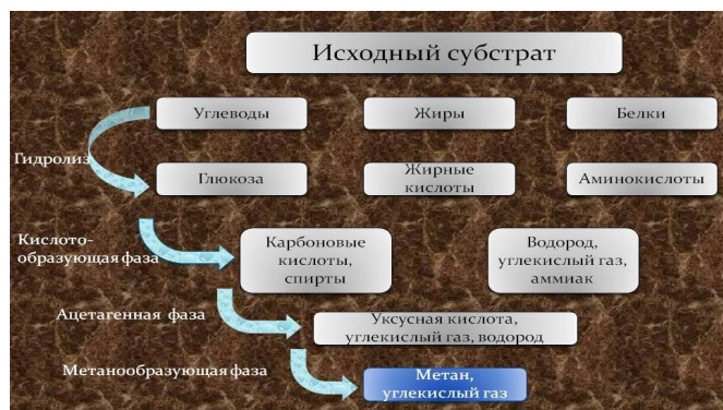
Рис. 2. Процессы образования биогаза
