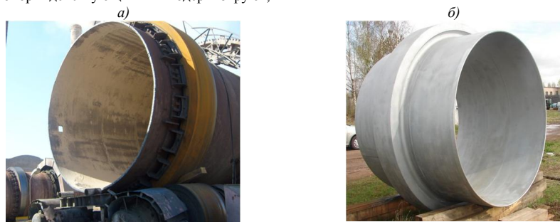
Рис. 1. Конструкции бандажей, применяемых на опорах вращающейся ТБ: а) бандаж типа «П»; б) бандаж типа «В»
