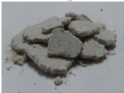
Рис. 2. Измельчаемый материал кварцитопесчаник: а – исходный материал; б – после обработки в ПВИ
