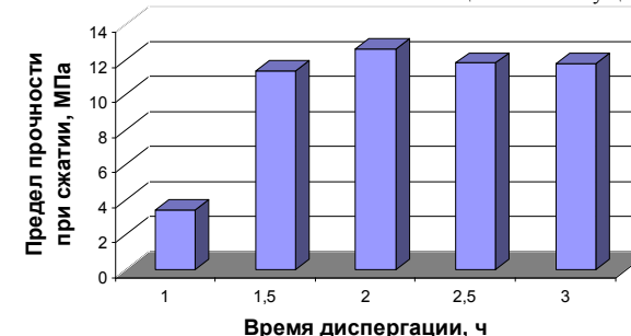
Рис. 4. Прочностные характеристики геополимерного вяжущего
